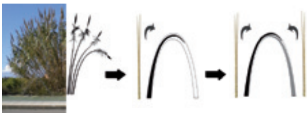
Figura 2. Esquema bàsic per a la construcció d'arcs (Canya Viva + Investigació Canyera). | Esquema básico para construcción de arcos (Caña Viva + Investigación Cañera).
